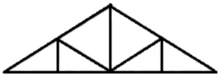
Жёсткость конструкции обеспечивают составляющие её треугольники.
